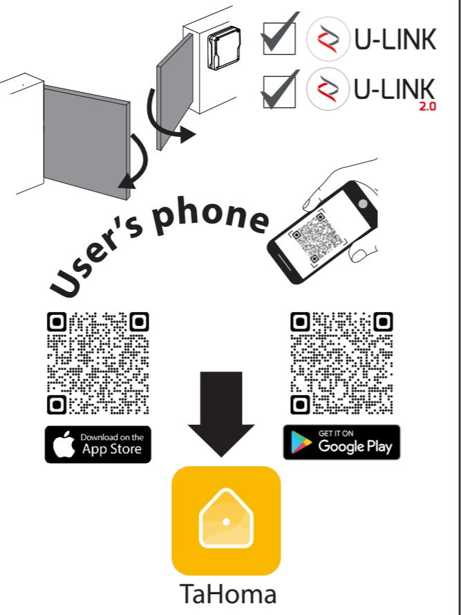
**Tahoma** è l'App per gli utenti finali per il controllo dell'automazione tramite smartphone. Installare l'App e seguire le istruzioni dell'App. È necessario usare una rete wifi a 2.4Ghz.
